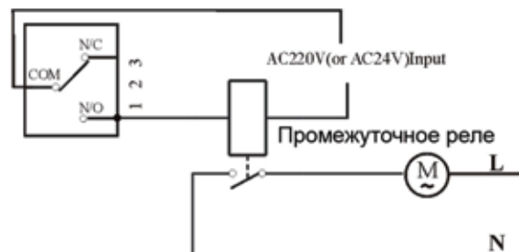
Управление повышающим насосом через промежуточное реле (ток > 5А)
