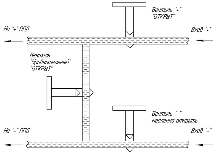
После опрессовки (сброса испытательного давления) закрыть сначала вентиль минусовой камеры, затем вентиль плюсовой камеры, уравнительный вентиль оставить открытым.
