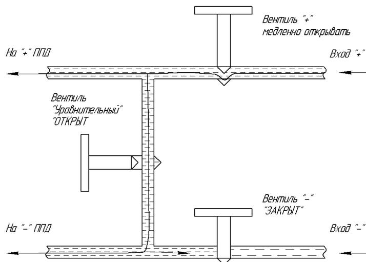
Затем плавно открыть вентиль минусовой камеры, контролируя перепад давления по корректору ЭК270. Значение перепада давления не должно превышать верхний предел измерения ППД, иначе преобразователь перепада давления может выйти из строя. Испытательное давление не должно превышать максимального рабочего давления преобразователя перепада давления – 1,6 МПа.
